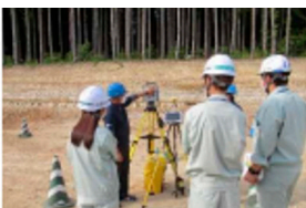
【秋田県会場】TLS 3次元レーザー測量
